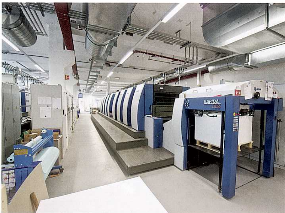
Beide KBA Rapida 106 sind mit Plattenzylinder-Direktantrieb Drive Tronic SPC und ziehmarkenfreier Anlage Drive Tronic SIS ausgestattet.
