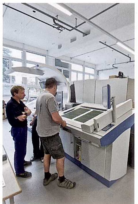
Ein weiteres Plus ist das Closed-Loop-Qualitätsregelungssystem QualiTronic professional.
