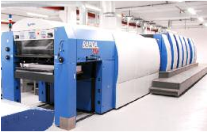
Blick in den Drucksaal: Links die Rapida 106-Sechsfarbenanlage mit Bogenwendung nach dem zweiten Druckwerk, Plattenzylinder-Direktantrieben und zusätzlichem Lackturm, rechts die in einer Linie aufgestellten Leitstände der beiden Rapida-Maschinen mit dazwischen platziertem DensiTronic-Pult für die Farbmessung und -regelung
