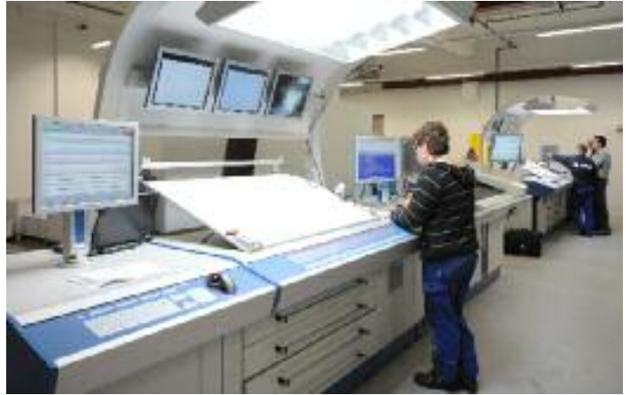
Blick in den Drucksaal: Links die Rapida 106-Sechsfarbenanlage mit Bogenwendung nach dem zweiten Druckwerk, Plattenzylinder-Direktantrieben und zusätzlichem Lackturm, rechts die in einer Linie aufgestellten Leitstände der beiden Rapida-Maschinen mit dazwischen platziertem DensiTronic-Pult für die Farbmessung und -regelung
