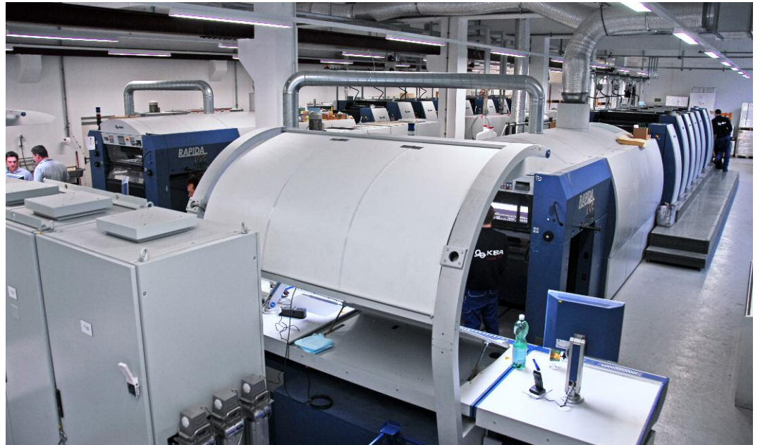
Blick in den Drucksaal: Oben die Rapida 106-Sechsfarbenanlage mit Bogenwendung nach dem zweiten Druckwerk, Plattenzylinder-Direktantrieben und zusätzlichem Lackturm, unten die in einer Linie aufgestellten Leitstände der beiden Rapida-Maschinen mit dazwischen platziertem DensiTronic-Pult für die Farbmessung und -regelung
