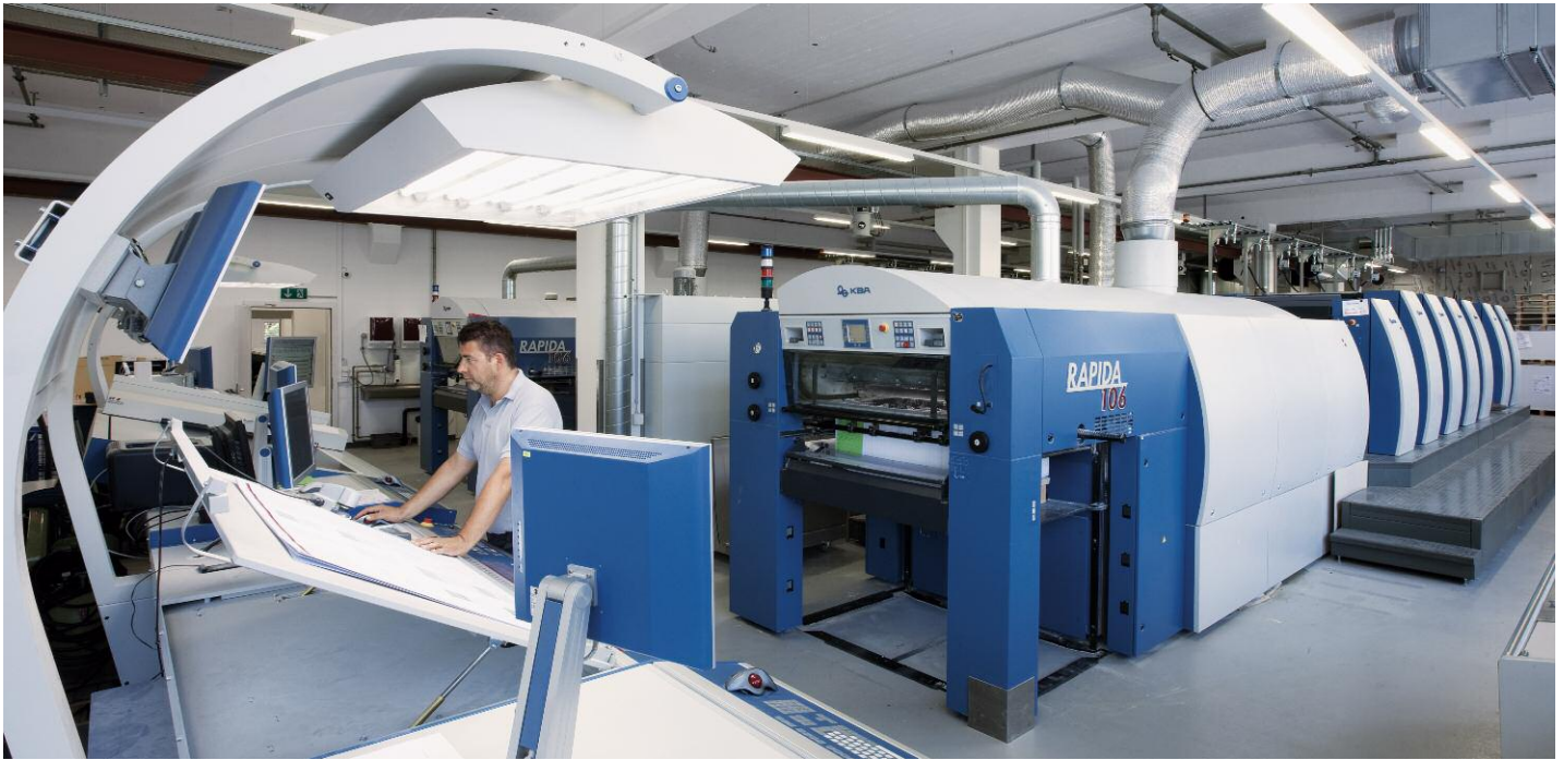
Die beiden Rapida 106 sind hoch automatisiert und mit modernster Inline-Mess- und Regeltechnik ausgestattet
