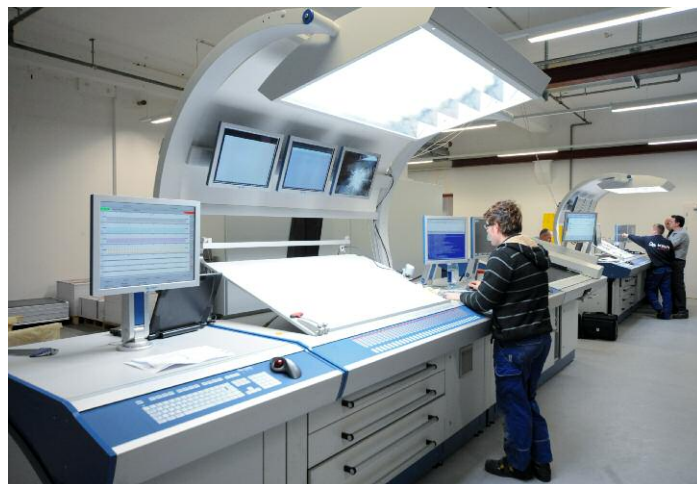
Blick in den Drucksaal: Oben die Rapida 106-Sechsfarbenanlage mit Bogenwendung nach dem zweiten Druckwerk, Plattenzylinder-Direktantrieben und zusätzlichem Lackturm, unten die in einer Linie aufgestellten Leitstände der beiden Rapida-Maschinen mit dazwischen platziertem DensiTronic-Pult für die Farbmessung und -regelung
